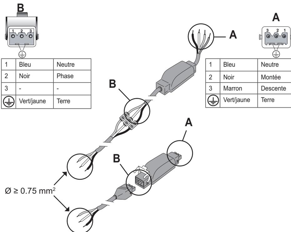
**i** Pour voir une bonne transmission du signal radio, il est nécessaire de faire sortir du caisson le câble d'alimentation de l'EVB - Slim receiver for Variation io sur au moins 30 cm.
